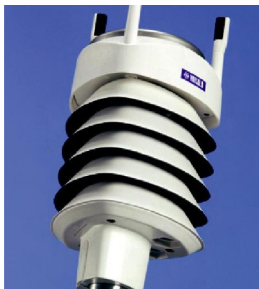
Sensory atmosférického tlaku, teploty a vlhkosti sú skombinované v zdokonalenom PTU module, ktorý je umiestnený vo vnútri špeciálne navrhnutého radiačného štítu.
